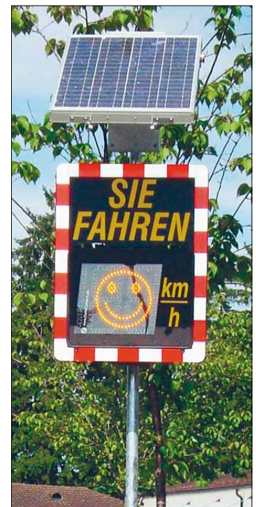
PRAKTISCH. Das neue Geschwindigkeitsmessgerät mit Tempoanzeige der Stadt Frauenfeld wird via Solarzellen mit Strom versorgt. Bild: zvg
