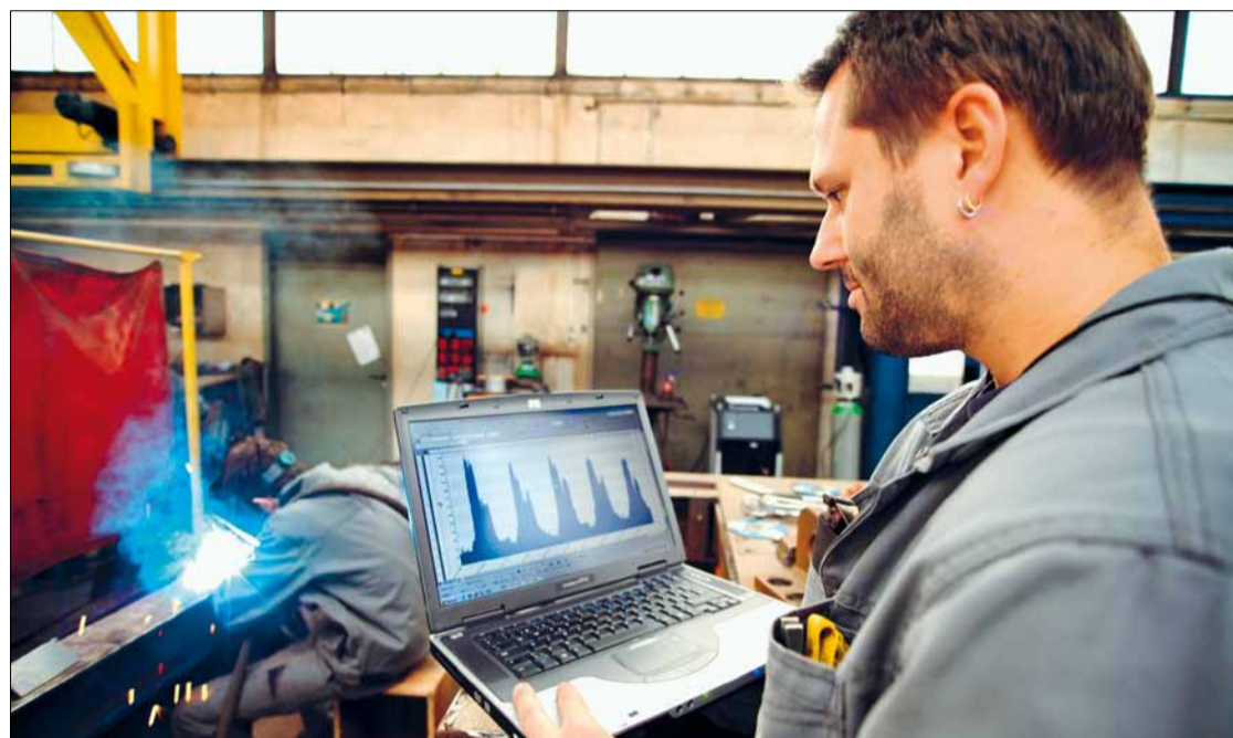
STROMSPITZEN IM BLICK. Klaus Kappeler von der Tuchs Schmid AG kann in der Werkstatt ab seinem Laptop den Lastverlauf des Stroms ablesen.
