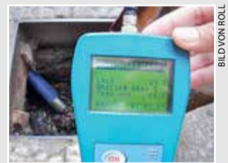
HORCHPOSTEN. Der «Ortomat» misst das Rauschen des Wassers in der Leitung.
